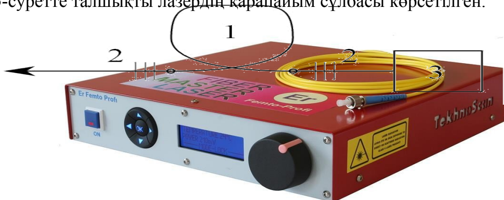
Сурет 2.5 - Толықтай талшықты фемтосекундты эрбийлі лазер 1 – белсенді талшық; 2 – Брэгг айналары; 3 – толтыру блогы
